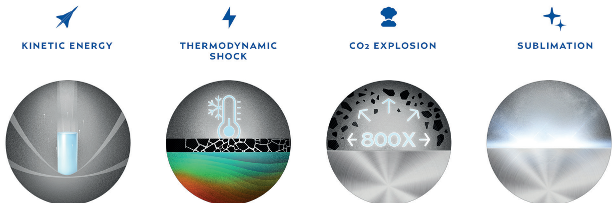
Cold Jet Trockeneisreinigung Funktionsprinzip
