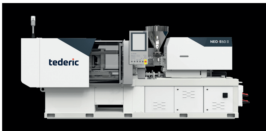
Leistungsstarke elektrische Kniehebel-Spritzgießmaschine Tederic NEO-E60 (Bilder Maschinen: Tederic Machinery Ltd.)
