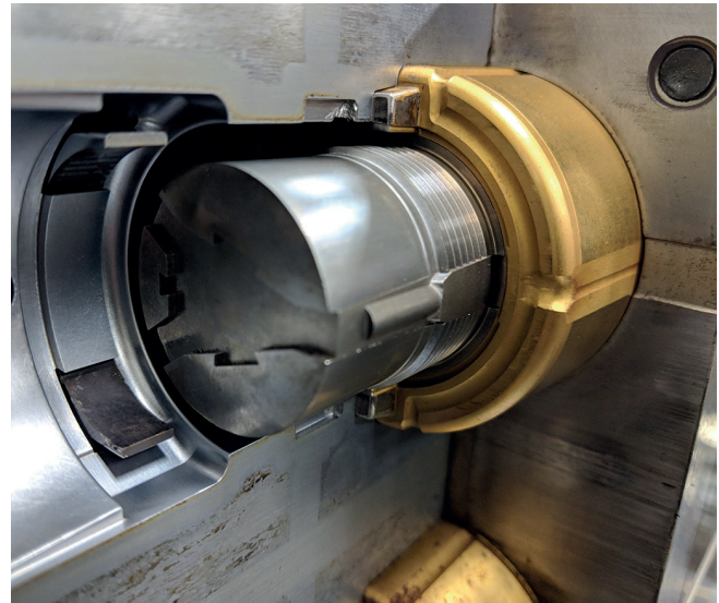
Nach dem Trockeneisstrahlen
