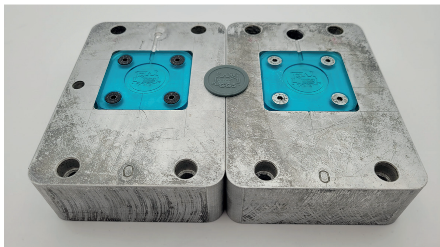
Produktion eines Prototypenteils in einem 3D gedruckten Werkzeug (Bild: SK Industriemodell GmbH)
