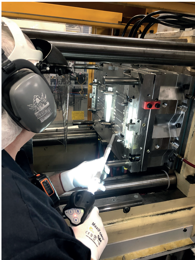
Entfernung von Ausgasungen mit Trockeneisstrahlen
