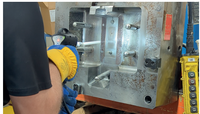
Trockeneisstrahlen einer Form (Bilder: Cold Jet GmbH)
